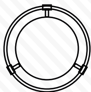
Vista desde arriba del centrador. Upper view of the centralizer
